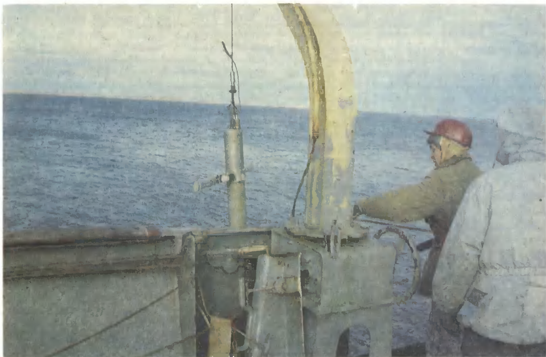
Спуск с борта «Дмитрия Менделеева» прибора для определения освещенности верхнего слоя воды.
